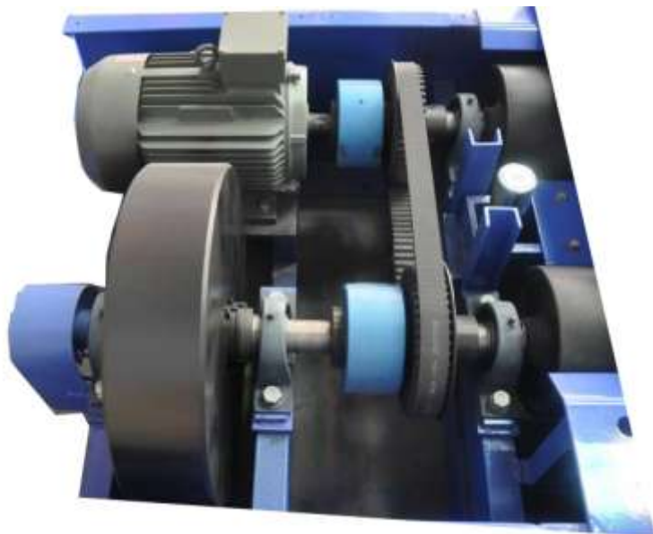
7.5kW反拖电机与飞轮
